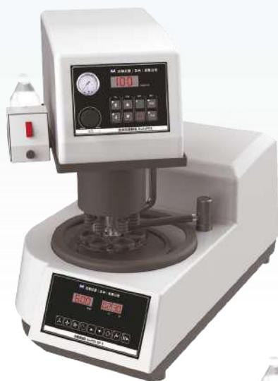
Однодисковый полностью автоматический шлифовально-полировальный станок AutoPOL GP-1C
