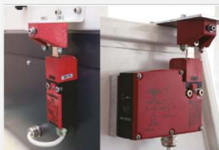
Аварийный выключатель «Шнейдер Электрик» (слева: стандартная комплектация / справа: опционально)
