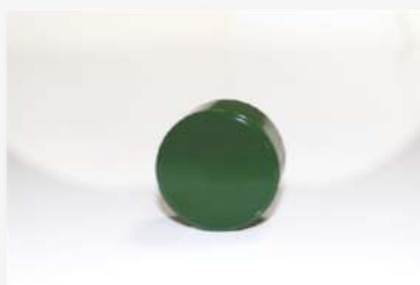
Скошенная конструкция пресс-формы, наличие у образца скоса удобно при последующей шлифовке и полировке
