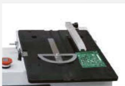
(Опционально) платформа, позволяет резать печатные платы
