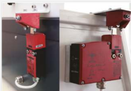
Аварийный выключатель «Шнейдер Электрик» (слева: стандартная комплектация / справа: опционально)
