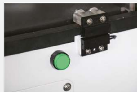
Магнитный аварийный выключатель При нажатии на зелёную кнопку аварийный выключатель перестаёт действовать, можно в ручном режиме резать большие обрабатываемые
