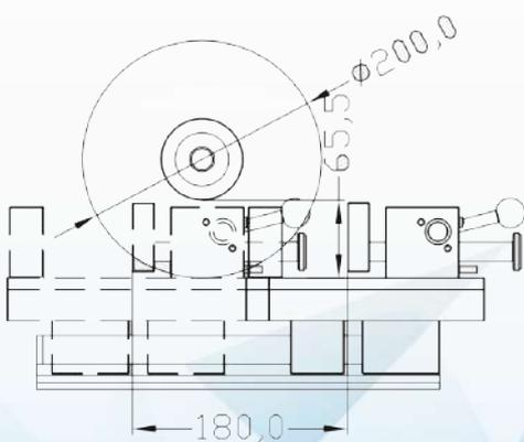
Процесс подачи и резки отрезным диском.
