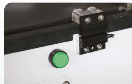
Магнитный аварийный выключатель При нажатии на зелёную кнопку аварийный выключатель перестаёт действовать, можно в ручном режиме резать большие обрабатываемые
